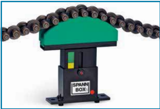
Spann-Box® Gr. 1 mit Bogenprofil aus Original Werkstoff "S"®grün® für eine Stauförderkette
