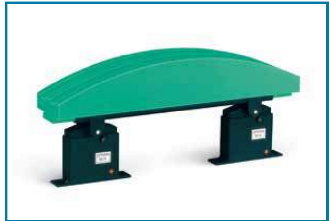
Spann-Box® Gr. 1 oder Gr. 2 als „Tandemspanner“ zum Spannen von Ketten mit sehr großen Teilungen
